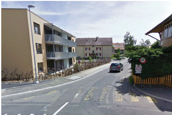
Schlechte Sichtverhältnisse aufgrund der Hecke
